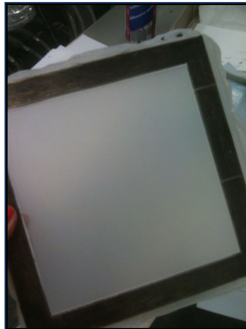
Ploča iz koje se režu uzorci za ispitivanje
